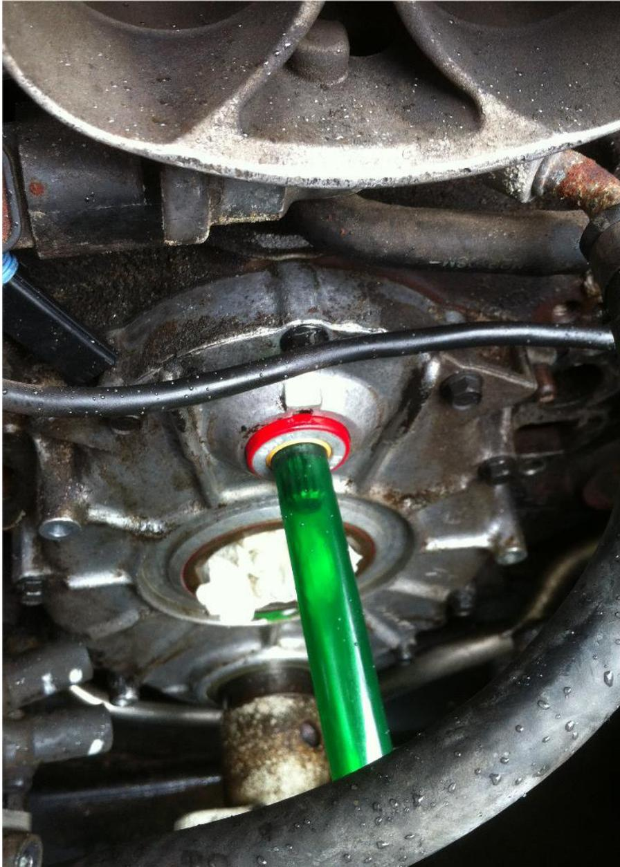
Wir sehen insgesamt drei Dichtringe, der obere ist Antrieb Wasserpumpe (**ACHTUNG:** zwischen diesem und der Wasserpumpe befindet sich eine Hülse als Antriebsadapter – der darf weder „verloren“ gehen beim werkeln, noch vergessen werden beim Einbau). Der Dichtring ist auf dem Bild noch nicht ganz drin, muss vorne bündig mit dem Gehäuse.
